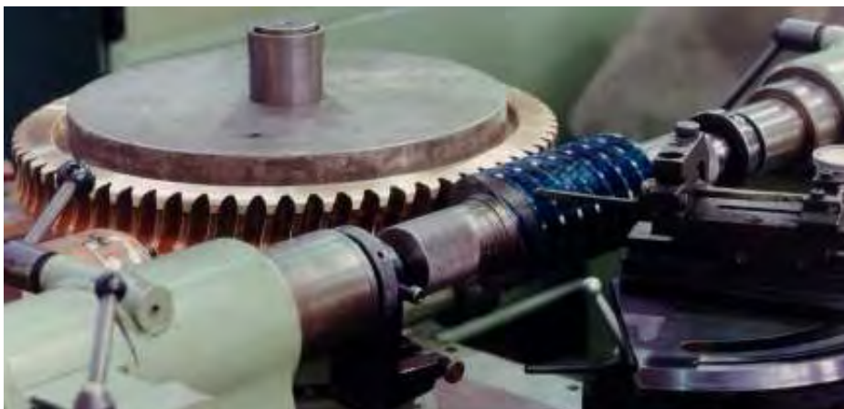
Bild 20: Schneckenrad auf Prüfgerät Fig. 20: Worm wheel on test rig Image 20: Roue sur appareil d'essai
