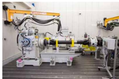
Специально сконструированные и изготовленные редукторы для испытательных стендов – это наш ежедневный хлеб.
