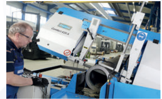
Jaespa Bandsäge Comfort-420A Bearbeitungsmaße: 600 mm x 420 mm Durchmesser: 420 mm
